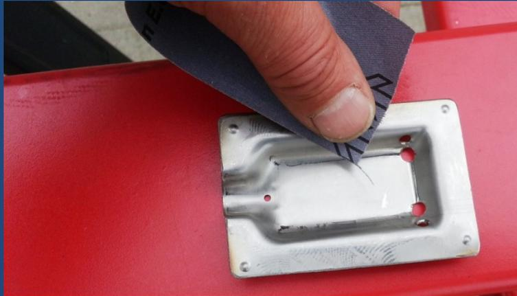
Schleifen Sie die inneren Kanten der DMS Abdeckhaube mit Schleifpapier
