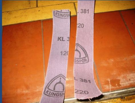
2. Reinigen Sie die Fläche mit Schleifpapier mit 120er, dann mit 240er Körnung
