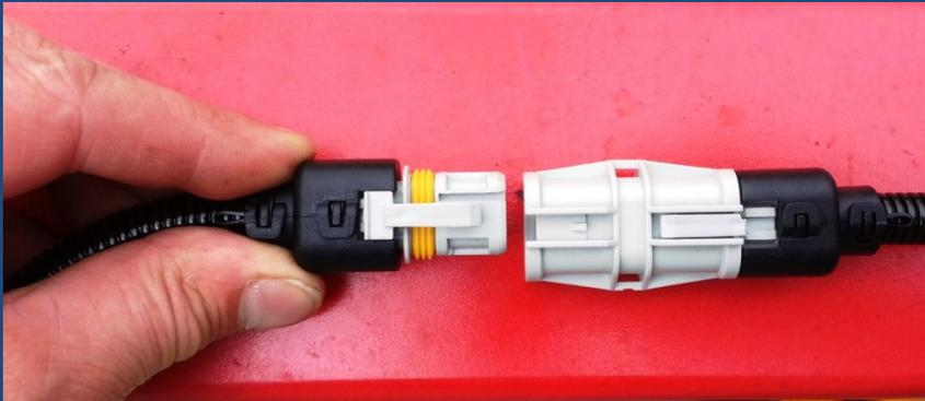
Schliessen sie den Stecker MAN an die entsprechende Buchse an. Stellen Sie sicher, dass die Verbinder einrasten (klickt).
