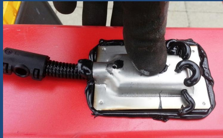
2. Platzieren Sie die Abdeckhaube über dem DMS Sensor und drücken diese leicht herunter – wobei Sie diese leicht seitlich hin und her bewegen – bis diese über dem DMS Sensor sitzt.
